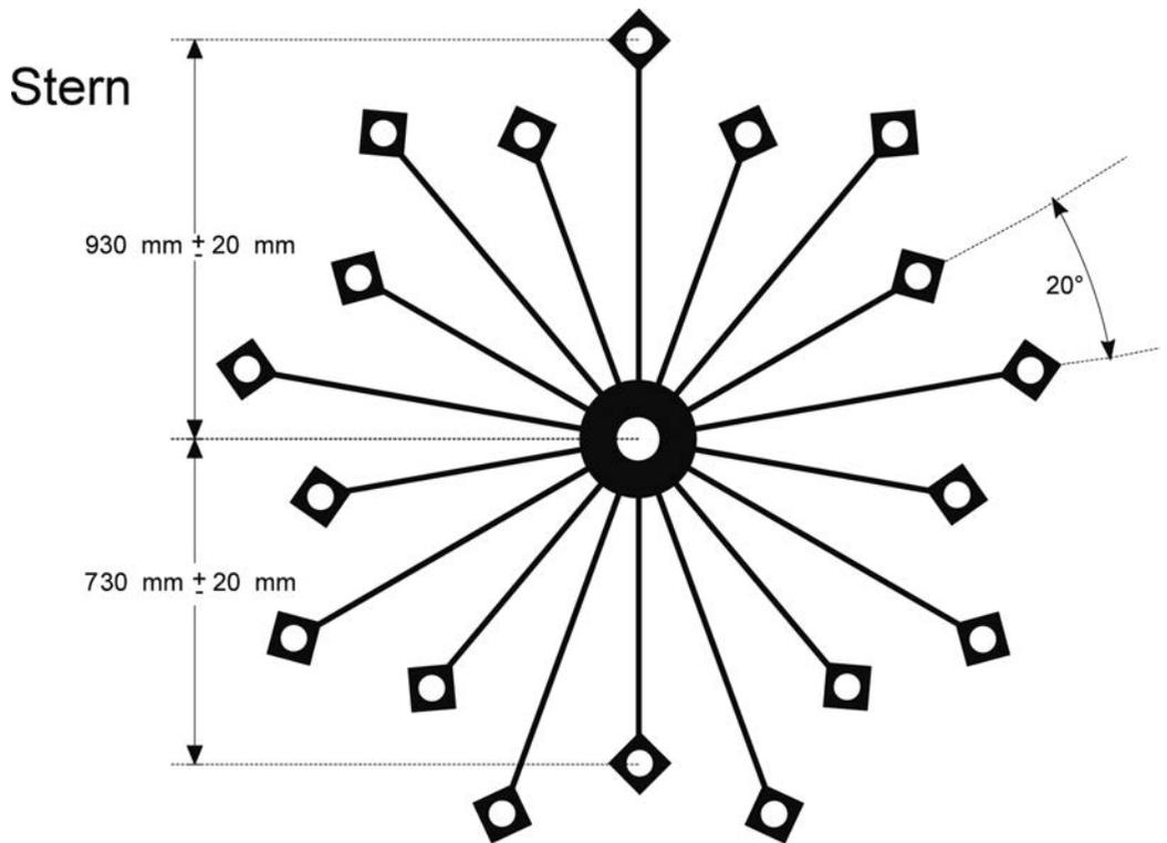
Die Haltestäbe sind in 90 mm und 150 mm Entfernung von der Plattlmitte zuerst von unten und dann von oben bis 1 mm über die Mitte des Haltestabs einzusägen.
