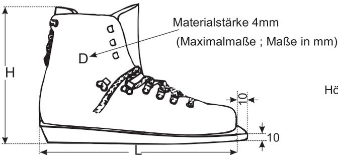
$$\begin{aligned} \text{Höhe} &: \text{Länge} \\ &= \\ \text{H} &: (\text{L} + 10\text{mm}) \\ &= \\ &2 : 3 \end{aligned}$$
