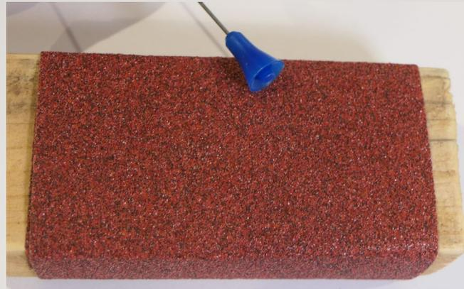
Ist der Pfeil zu groß, so muss der Durchmesser des Konus durch ein Anschleifen mittels Schleifpapier reduziert werden.
