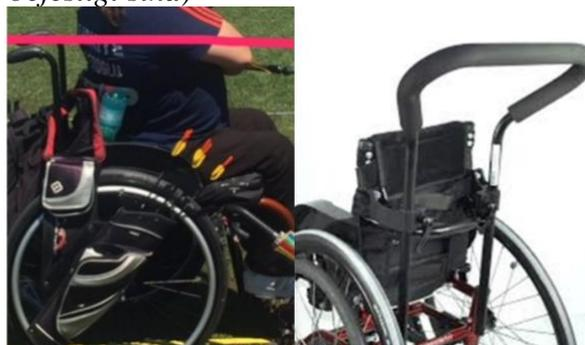
**Abbildung 21:** *Schiebegriffe, die nicht an der Rückseite des Rollstuhls befestigt sind*
