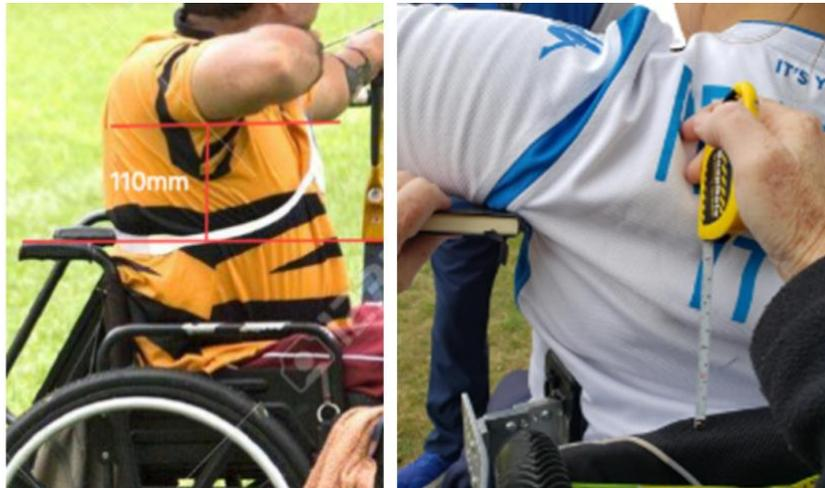
**Abbildung 20:** *Mindestabstand von der Achselhöhle: 110 mm*
