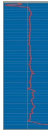
Beispiel einer Druckverlaufskurve mit Direktabzug; Abzugsgewicht: 90 g
