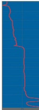
Beispiel einer Druckverlaufskurve mit Vorzug; Abzugsgewicht: 75 g
