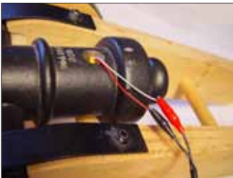
Abb. 20: Vorderladerkanone mit elektrischer Zündung
