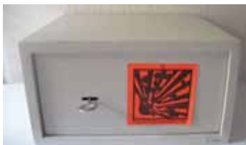
Abb. 4: Stahl-Behältnis zum Aufbewahren von Böttlerpulver
