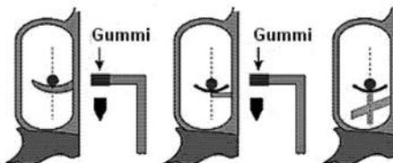
Es muss ein Gewicht mit einer Metall- oder Gummischneide oder eine gummibesetzte Rundform benutzt werden. Eine Rolle am Abzugsgewicht ist nicht gestattet. Es darf nur ein Prüfungsgewicht ohne Feder(n) oder anderes Zubehör benutzt werden
